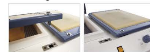
Система закрытия плиты
